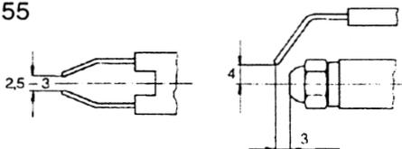
Die Elektroden sind werkseitig eingestellt. Die angegebenen Maße dienen zur Kontrolle.
