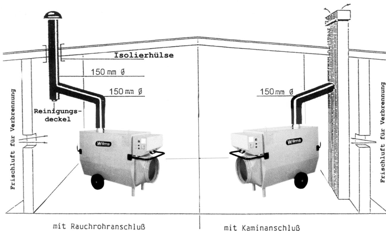
Das waagrecht verlegte Rauchrohr bis zum eigentlichen Kamin muß mit einer Steigung installiert werden.
